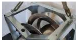
Montage von Hebeösen an dafür vorgesehenen Stellen
